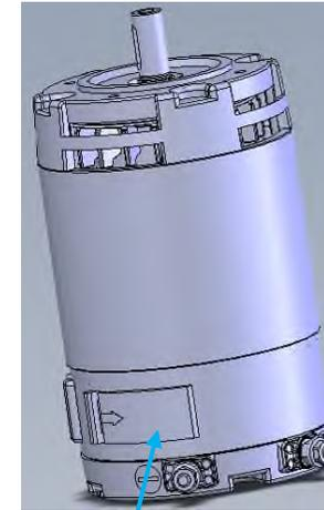
Die Abdeckung über den Kohlebürsten ist wie in den Bildern 7/2, 7/3 und 7/4 gezeigt wieder zu schließen. Dabei ist darauf zu achten, daß der Kunststoffverschluß über einem Bürstenausschnitt des Motorgehäuses zu liegen kommt.
